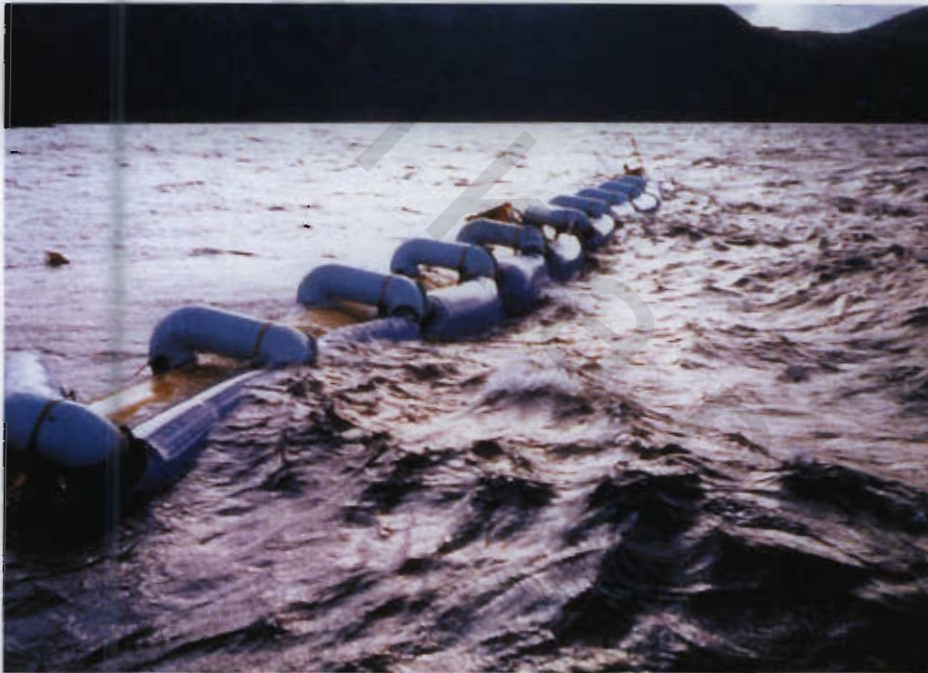
يطفو المولد كلام CLAM على سطح الماء، وتتولد الكهرباء عندما تدفع حركة الموج الهواء إلى داخل المولد.
