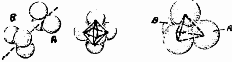
شكل (a١٧) تكون الثقوب رباعية الاسطح . شكل (b ١٧) تكون الثقوب ثمانية الاسطح.
