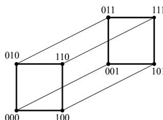
يظهر الشكل أعلاه  $Q_3$ ، يُعدُّ المكعب الزائدي مهندساً معمارياً طبيعياً للحاسوب، حيث يمكن للمعالجات التواصل مباشرة إذا ارتبطت برؤوس متجاورة في  $Q_k$ ، علماً بأن الترتيبات التي لها  $K$  من الإحداثيات والتي تمثل الرؤوس التي تعمل بوصفها عناوين للمعالجات.
