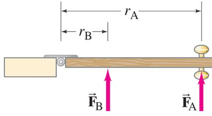
الشكل 8-10 تطبيق القوة نفسها، ولكن بذراع رافعة مختلف،  $r_B$  و  $r_A$ . فإذا كانت  $r_A = 3r_B$ ، للحصول على الأثر نفسه (التسارع الزاوي)، يجب أن تكون  $F_B$  ثلاثة أمثال  $F_A$ ، أو  $F_A = \frac{1}{3}F_B$ .
