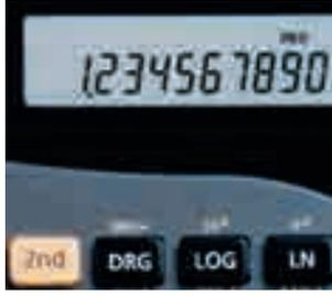
الشكل 24 - 52. شاشة حاسبة LCD الأجزاء السوداء أو عناصر الصورة يؤثر فيها جهد. لاحظ أن رقم 8 يستخدم العناصر السبعة كلها. أما الأرقام الأخرى فتستخدم أقل من ذلك.
