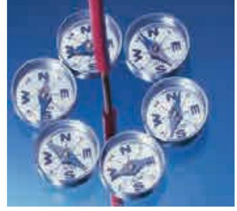
الشكل 20 - 8 (أ) انحراف إبرة البوصلة بالقرب من سلك يحمل تيارًا كهربائيًا يربنا وجود مجال مغناطيسي ويبيّن اتجاهه. (ب) خطوط المجال المغناطيسيّ حول سلك مستقيم يمرّ فيه تيار كهربائيّ. (ج) قاعدة اليد اليمنى لتحديد اتجاه المجال المغناطيسيّ: إذا أشار الإبهام إلى اتجاه التيار الكهربائيّ، فإنّ الأصابع الأخرى تشير إلى اتجاه المجال المغناطيسيّ.
