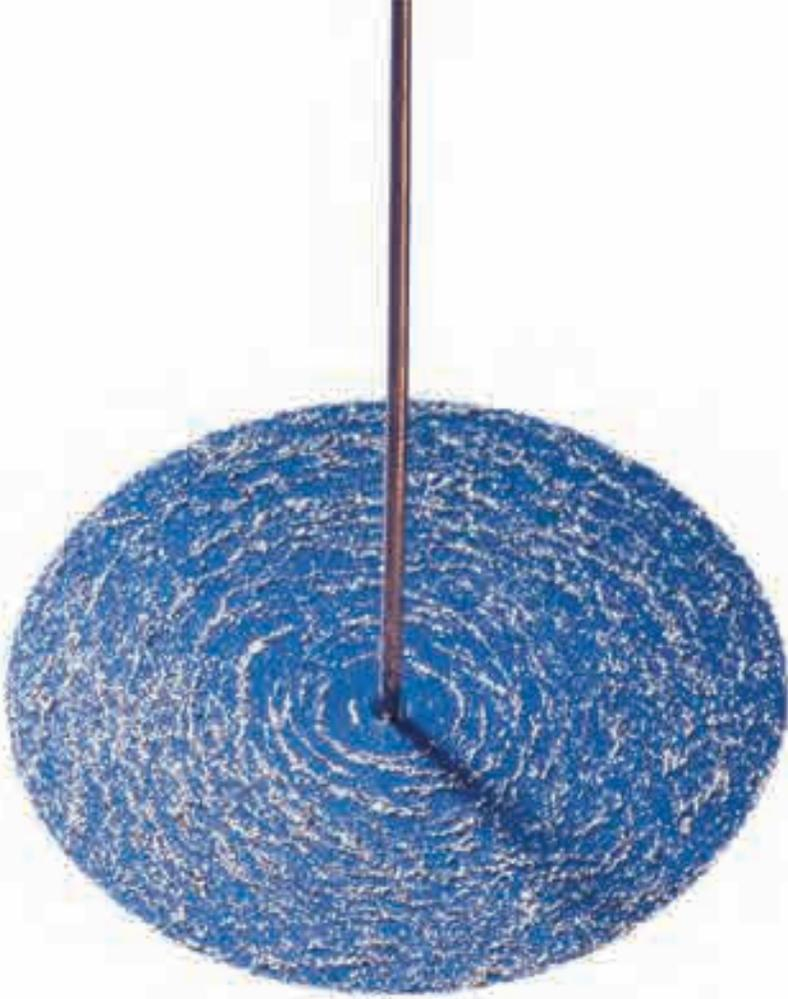
ينتج المغناطيس مجالاً مغناطيسيًا وكذلك يفعل التيار الكهربائي، فعند مرور تيار كهربائي في سلك مستقيم، فإنه ينتج مجالاً مغناطيسيًا حوله، ويسبب ترتيب برادة الحديد باتجاه المجال. وتكون خطوط هذا المجال حول السلك على شكل دوائر.
