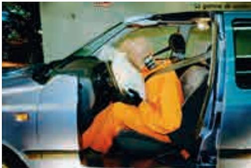
الشكل 2-14 ينتفخ كيس الهواء عند التصادم.
