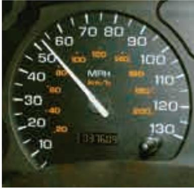
الشكل 2 - 8 يبين مقياس السرعة في السيارة وحدة القياس mi/h باللون الأبيض ووحدة القياس km/h باللون البرتقالي.
