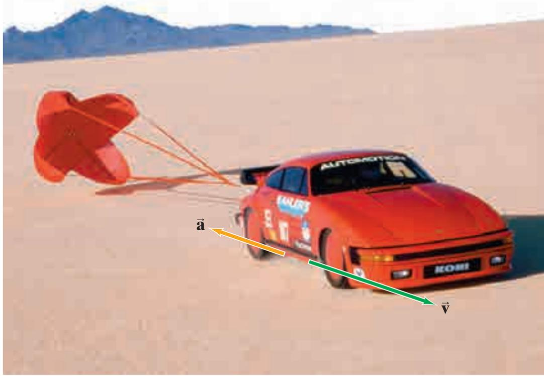
أطلقت سيارة ذات سرعة عالية مظلة كي تقلل من سرعتها على نحو سريع. يبين السهم الأخضر اتجاه سرعة السيارة، أما السهم الذهبي فيشير إلى اتجاه تسارعها. يتم وصف الحركة باستعمال مفاهيم السرعة والتسارع. أحياناً قد يكون التسارع معاكساً ( $\vec{v}$ ) لاتجاه السرعة ( $\vec{a}$ ) كما هو مبين في الصورة. وسندرس أيضاً بالتفصيل الحركة بتسارع ثابت، وكذلك الحركة العمودية للأجسام التي تسقط تحت تأثير الجاذبية.
