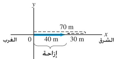
الشكل 2 - 4 يمشي شخص ما 70 m نحو الشرق، ثم 30 m نحو الغرب. إن المسافة الكلية التي قطعها هذا الشخص تساوي 100 m (المسار المبين بالخط الأسود المقطع) ولكن إزاحته تساوي 40 m نحو الشرق، كما هو مبين بالسهم الأزرق.
