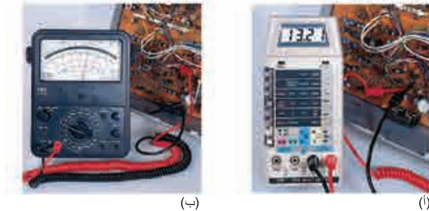
الشكل 19-29 (أ) جهاز قياس متعدد الأغراض ذو مؤشر يستخدم كفولتميتر. (ب) جهاز قياس رقمي إلكتروني.
