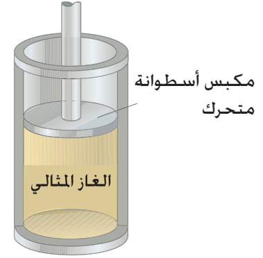
الشكل 15 - 1 غاز مثالي داخل أسطوانة ذات ذراع متحرك
