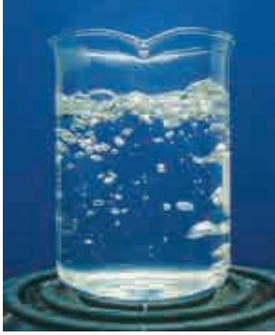
الشكل 13 - 23 الغليان: فقاعات بخار الماء تطفو نحو الأعلى من القاعدة (حيث درجة الحرارة الأعلى).
