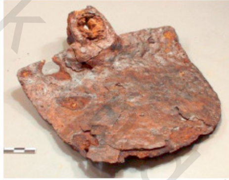
الشكل (٢٨). مجراف من الحديد تغطي سطحه طبقات قشرية أو صفائحية من نواتج صدأ الحديد.
