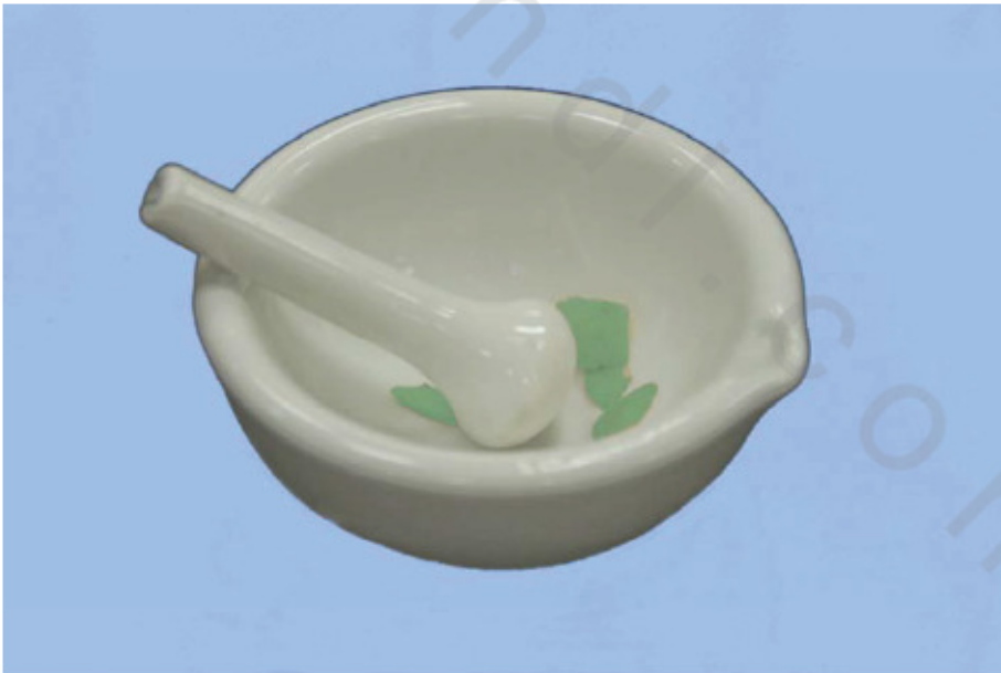
الشكل رقم (٣٥). يوضح الهاون الخزفي ويده Morter & Pestle لطحن العينات النباتية لاستخلاص بعض المركبات النباتية .
