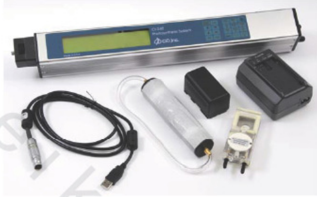
الشكل رقم (٢٣ - أ) يوضح جهاز حديث لقياس معدل البناء الضوئي Photosynthesis apparatus
