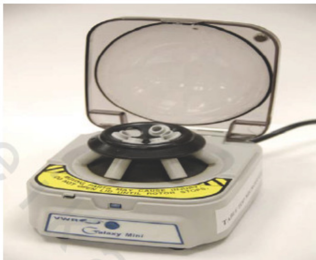
الشكل رقم (١٦-أ). يوضح جهاز الطرد المركزي الدقيق Micro Centrifuge.
