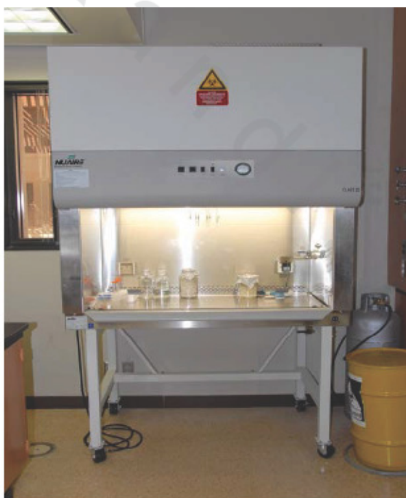
الشكل رقم (١٤). يوضح وحدة أو كابينة استخراج الـ DNA وتحضير محلول PCR
