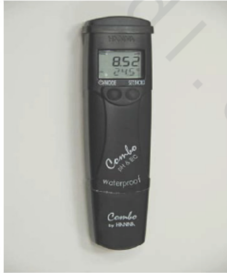
الشكل رقم (٢). جهاز حقل لقياس الرقم الهيدروجيني pH Meter.
