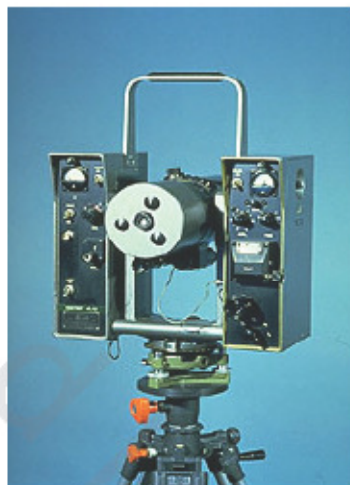
الشكل رقم (٧,٥). جهاز القياس معرض المدى (١٠ كم إلى ٢٥ كم) - Geodimeter 6A [١٤].
