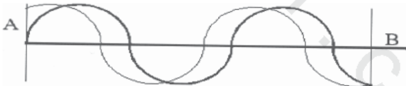
الشكل رقم (٧,٩). فرق الطور بين الموجة المرسله (الخط الفعلي) والموجة المستقبلة (الخط الخفيف) يقاس عند لحظة الإرسال A.
