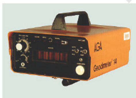
الشكل رقم (٧,٦). جهاز القياس معرض المدى ، يقيس حتى ١٠ كم - Geodimeter 14 [١٤].
