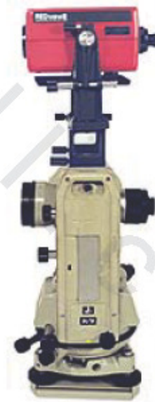
(أ) جهاز قياس المسافة الكهرومغناطيسي على رأس جهاز قياس الزوايا [١٣].
