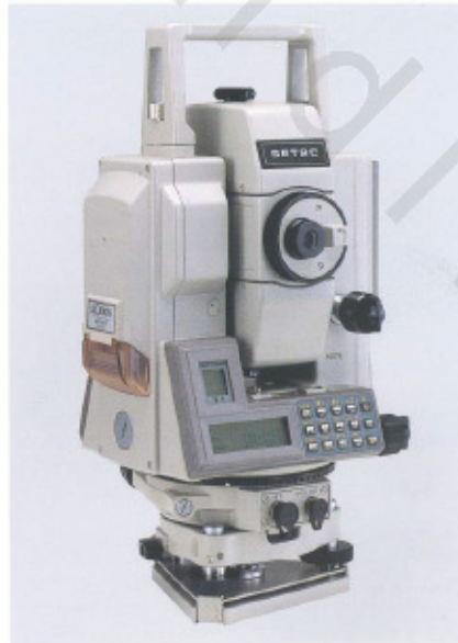
الشكل رقم (١٠، ٧). جهاز المسطرة الحاملة لشركة سوكيا SET2C [٧].
