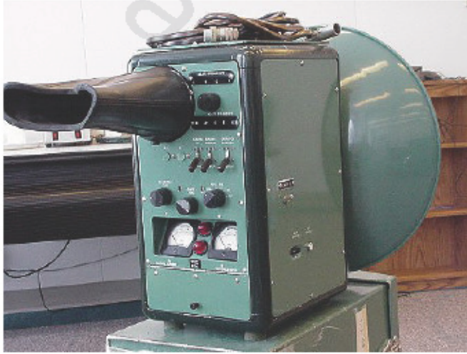
الشكل رقم (٧,٧). الجهاز الإلكتروني لقياس المسافات الطويلة 50 كم Tellurometer MRA1 [١٤].
