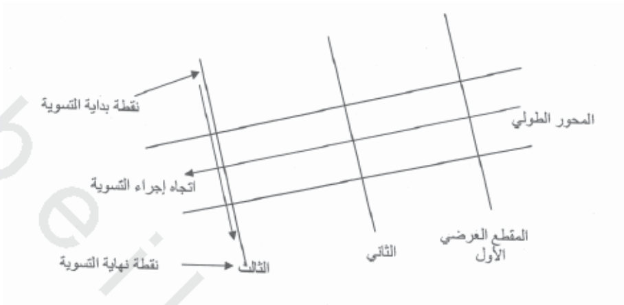
الشكل رقم (٦،٤). الطريقة الثالثة: تبدأ التسوية من أحد الجانبين مروراً بنقطة المحور.
