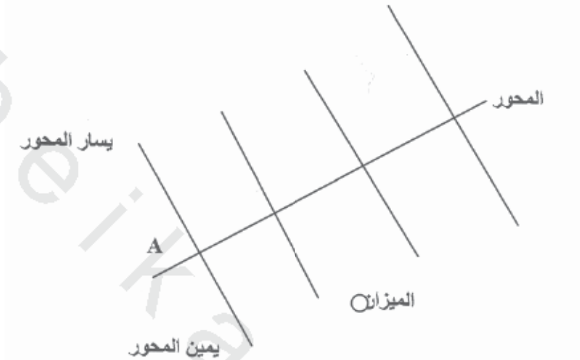
الشكل رقم (٦, ٦). طريقة المحور أو الإشعاع.
