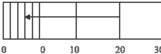
الشكل رقم (٣,٧). مقياس بسيط 1:1000 يقرأ 2m - السهم يمثل مسافة 24m.
