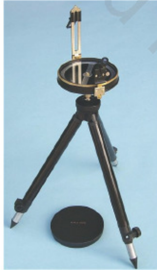
الشكل رقم (٣،٩٢). البوصلة مهيئة على الحامل المعدني [٧].
