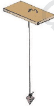
الشكل رقم (٨,٨). الشاهول - ثقل مخروطي بطرف الخيط [٨].
