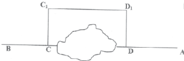
الشكل رقم (٢, ٢٦). المسافة المطلوبة CD تساوي المسافة التي يمكن قياسها C1D1.
