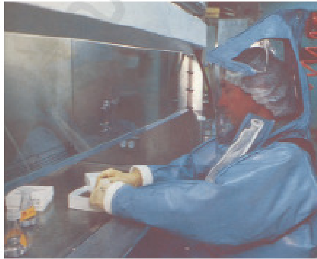
الشكل رقم (٨٠). كبائن خاصة لحقن وزراعة الفيروسات والأحياء الدقيقة الممرضة (Laminar Sterile air flow).
