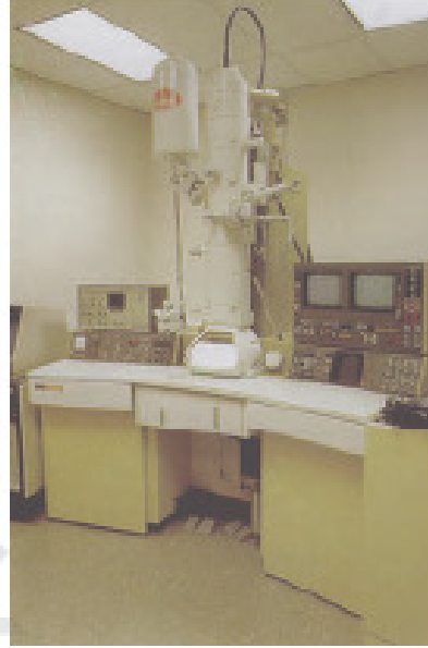
الشكل رقم (١٩). صورة ضوئية للمجهر الإلكتروني الحديث والذي يجمع وظائف كلاً من المجهر الإلكتروني النفاذ والنسج (عن: Madigan, et al., 1997).
