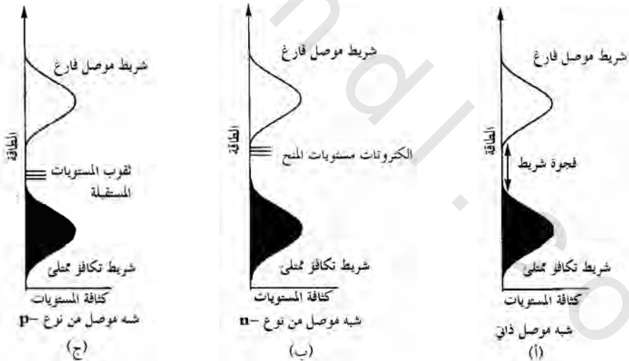
الشكل رقم (٢،٢١). رسوم كثافة المستويات لـ: (أ) شبه موصل حقيق. (ب) شبه موصل من النوع n-p. (ج) شبه موصل من النوع p-
