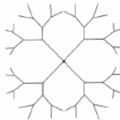
الشكل رقم (٢,٢). رسم تخطيطي للبوليمر النجمي أو الشجري.
