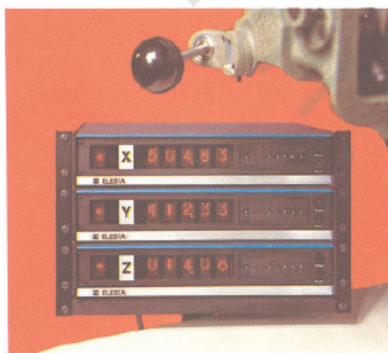
الشكل رقم (٧،٦). آلة تسجيل الإحداثيات الرقمية EK-22
