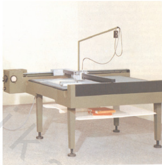
الشكل رقم (٧,٨). طاولة الرسم الأتوماتيكي [16].
