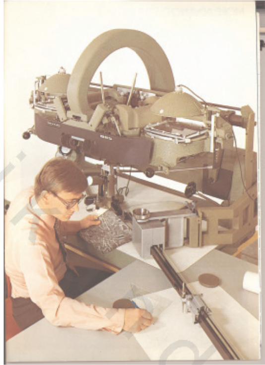
الشكل رقم (٧،٥). إحاطة بيانات إلى لوحة الرسم من الصورة الورقية [16].
