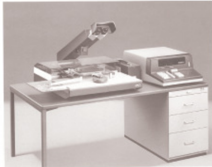
الشكل رقم (٣,٥). جهاز قياس الإحداثيات على الصورة المفردة للقردة Zetax PK1 [13].
