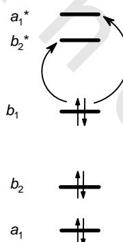
الشكل رقم (١١.١). الانتقالات الإلكترونية منخفضة - الطاقة المختلطة في  $H_2O$  (أسقط  $1a_1$  MO غير - الرابط المبين بالشكل ٧,٣ للإيضاح).
