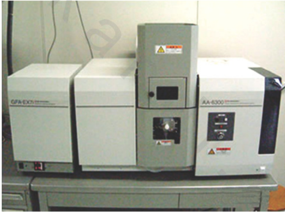
شكل (١١٥). جهاز طيف الامتصاص الذري لتقدير تركيز العناصر Atomic absorption spectrophotometry.
