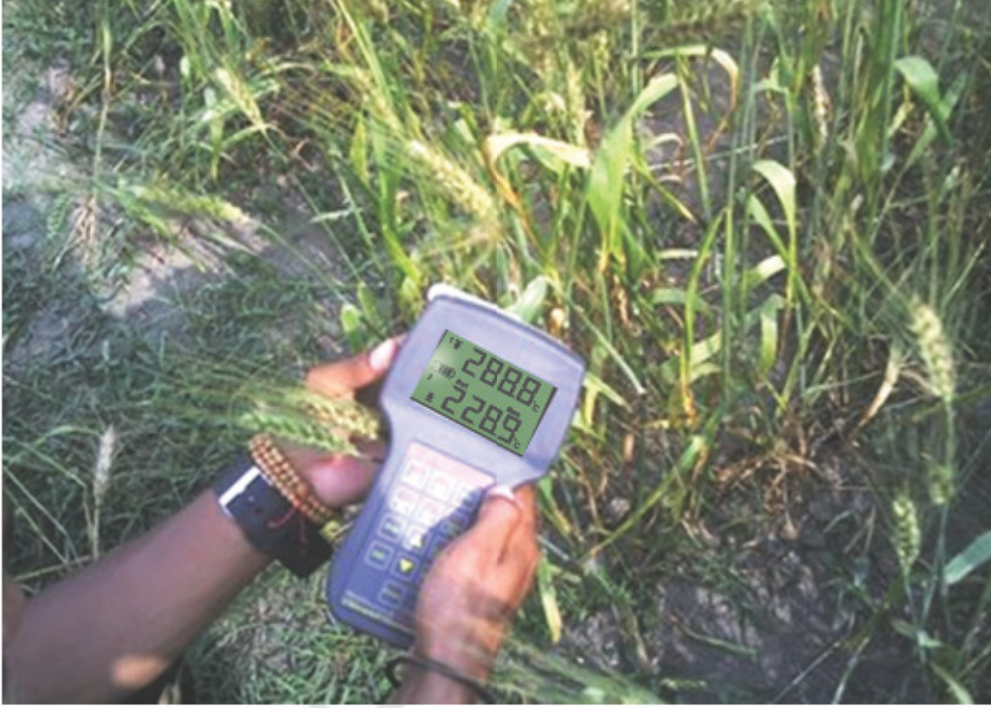
شكل (١٠٥). يوضح طريقة استخدام جهاز قياس شدة الإضاءة.
