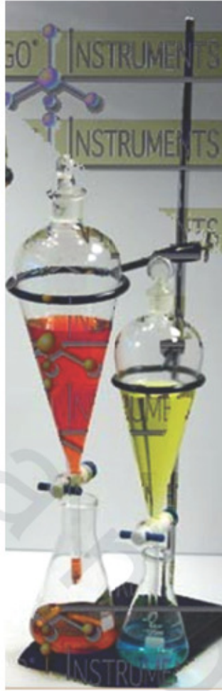
شكل (٣٤ب). يوضح أقماع الفصل Separatory funnels.
