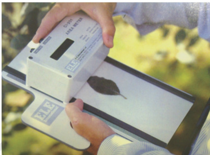
شكل (٥١ ب). طريقة استخدام جهاز قياس مساحة سطح ورقة النبات.
