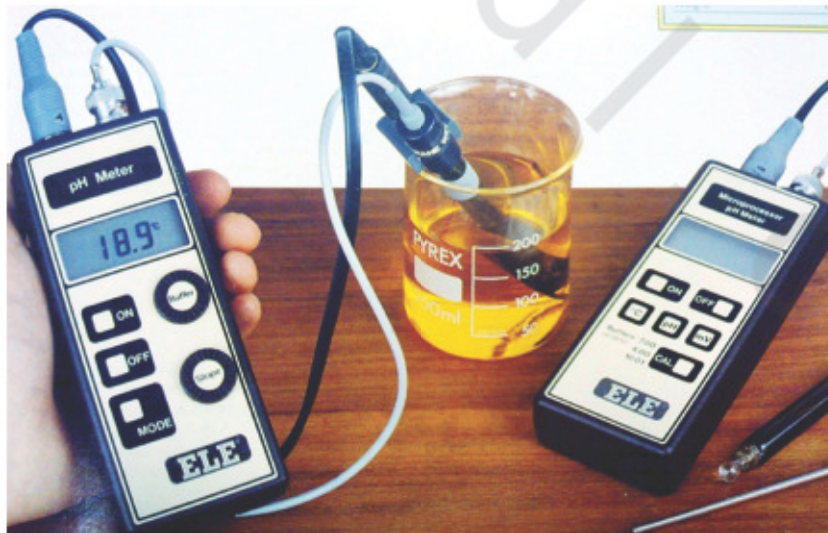
شكل (٤٠). أجهزة قياس الرقم الهيدروجيني والتوصيل الكهربائي.
