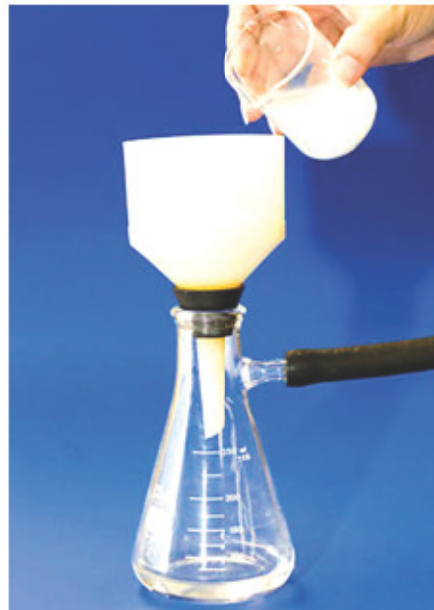
شكل (١٣٤). يوضح فصل المستخلص النباتي باستخدام أقناع الترشيح.
