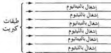
الشكل رقم (٦, ١١). نموذج إشغال لفجوات ثمانية بين طبقات عكمة التراص من ذرات الكبريت في \text{LiTiS}_2 .
