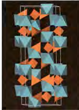
الشكل رقم (٥, ١٤). تركيب NZP. شاهد إدراج اللون في الصفحة السابقة. Na أرجواني، P بني و O أحمر.
