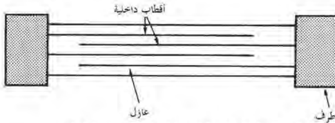
الشكل رقم (٩,٢١). مقطع خلال مكثف متعدد الطبقات.
