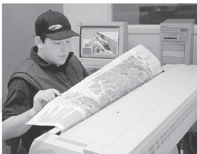
الشكل (١١٤). ماسح ضوئي يتم فيه مسح بواسطة أسطوانات.
