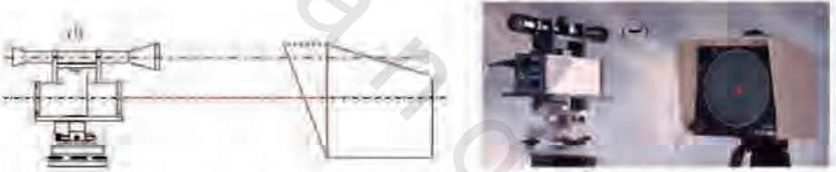
الشكل رقم (٥،٢١). (أ) رسم تخطيطي (ب) صورة فوتوغرافية لنظام PSD و رأس ليزري لقياس حركة وسوية بناء (Noptel Oy).
