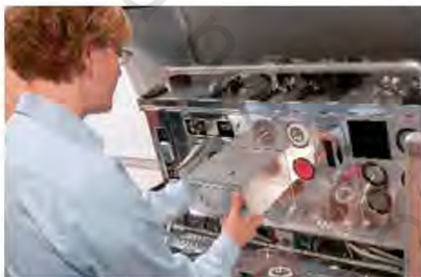
الشكل رقم (٢, ١٢). رأس قياس لجهاز متعدد الوظائف لمختبر الورق من أجل جودة الورق (الصورة مأخوذة بالإذن من شركة ميتسو للأتمتة (Metro Automation)).
