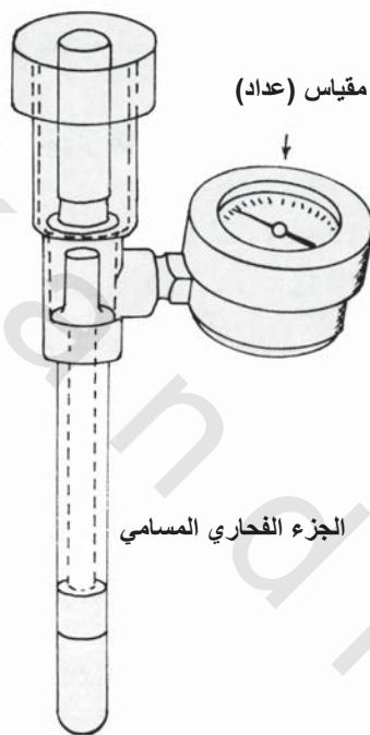
الشكل رقم (٣-٤). رسم تخطيطي لقياس التوتر السطحي من الأنواع التجارية والمكون من جزء بلاستيكي موصل به الجزء الفخاري المسامي ومقاييس يسجل القراءات، والغطاء في قمته يُغلق الفتحة التي يملا عن طريقها الجهاز بالماء.
