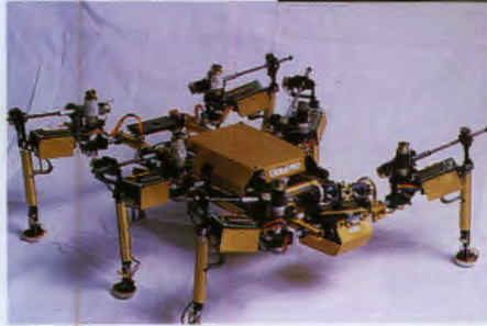
هذا الإنسان الآلي يشبه الحشرة ، وله أرجل مفصليّة ويمكن له أن يتحرك فوق الأسطح الوعرة.
