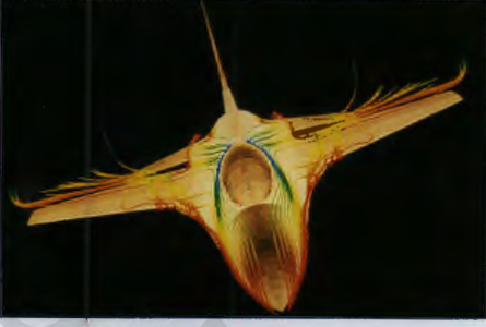
صورة كمبيوترية لتدفق الهواء فوق طائرة نفاثة.
