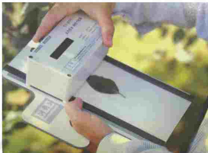
شكل (١٥ب). طريقة استخدام جهاز قياس مساحة سطح ورقة النبات.
