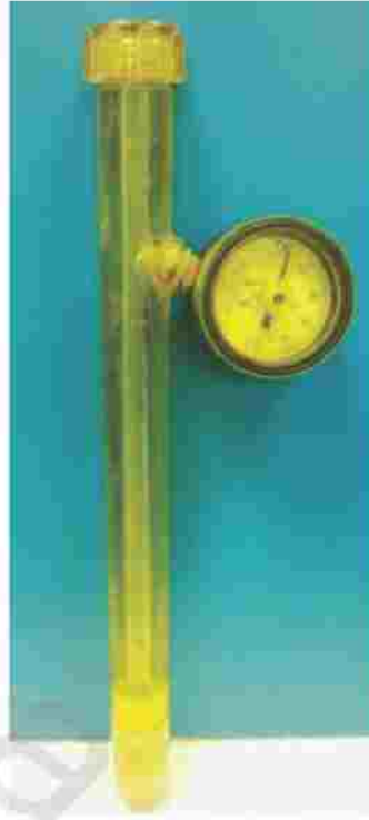
شكل (٤٤). جهاز Tensiometer لقياس المحتوى المائي للتربة.
