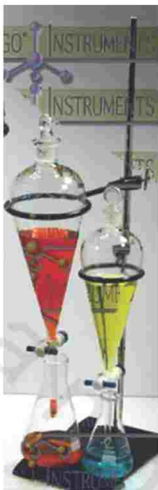
شكل (٣٤ب). يوضح أقماع الفصل Separatory funnels.
