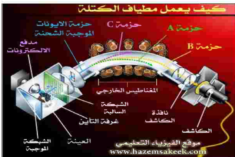
الشكل (8) آلية عمل مطياف الكتلة
