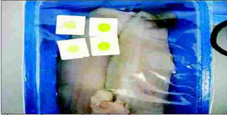
الشكل (78) صورة تمثل إحدى العبوات الغذائية المصنعة من متراكبة البلمرات المدعمة بحبيبات نانوية من الكربون. وتظهر في الصورة المادة الغذائية الطازجة بعد أن تم تغليف عبوتها بغطاء رقيق شفاف مصنوع من مادة البلمر جرى تدعيمه بحبيبات من ثاني أكسيد التيتانيوم
