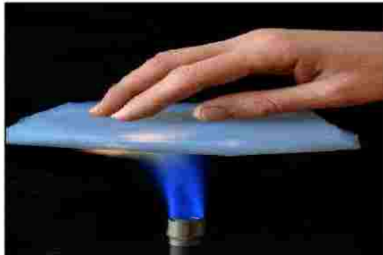
الشكل (123) المقرة الخارقة لهلاميات الهواء في منع أنتقال حرارة شعلة ملتهبة
