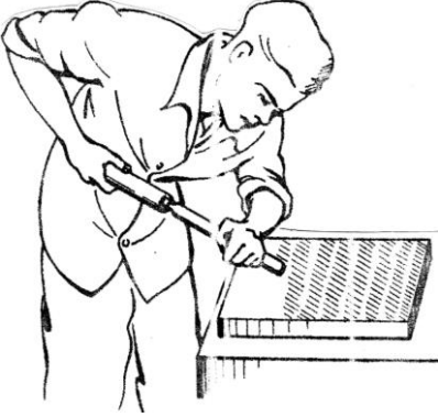
شكل 1 - 37 الاستخدام الصحيح للمكشطة اليدوية المستوية
