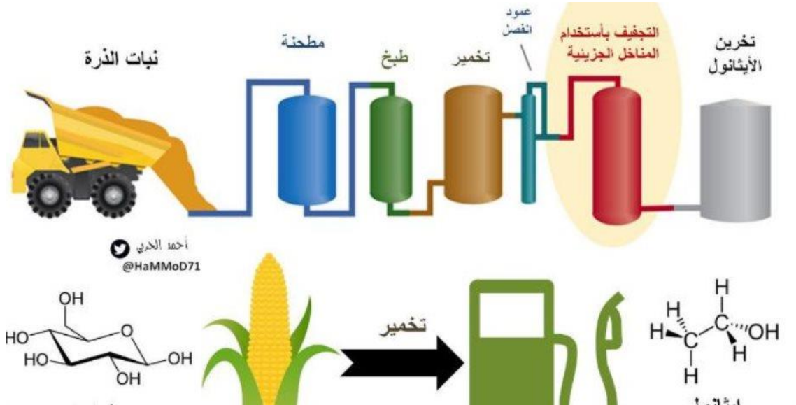
شكل (٧-١٠) مراحل تصنيع الوقود الحيوي (كحول الإيثانول) من حبوب الذرة.
