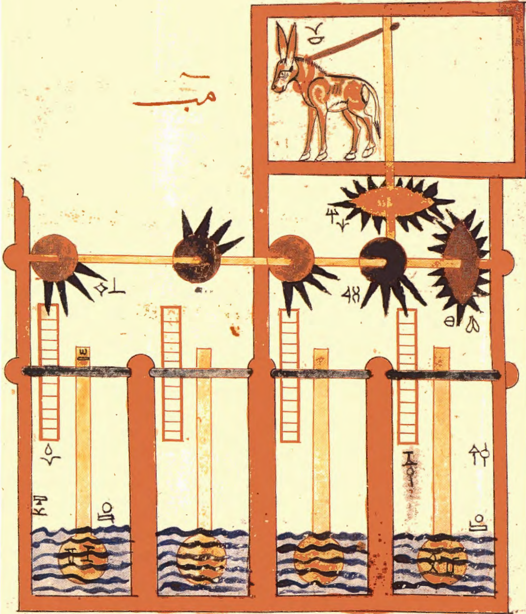
الشكل (3،6) مثال على آلة رفع ماءٍ بسلسلةٍ من الخزانات وباستخدام قوة الحيوان لتحريكها.
